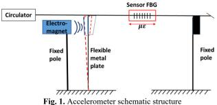
Fig. 1. Accelerometer schematic st
