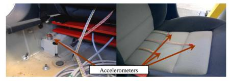
Fig. 9. Accelerometers
